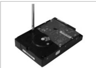
④ HDD의 볼트 4개를 조여 주십시오. (각각의 나사를 3번 돌립니다.) HDD를 바닥면의 구멍 4개에 맞추십시오.
